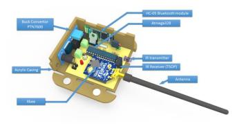
Fig. 2. ZigBee Box
