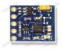
Figure 4: MagnetometerQMC5883
