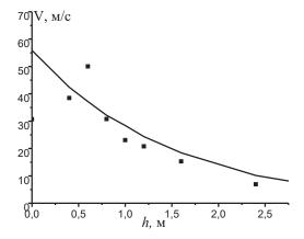
**Рисунок 5.** Зависимость скорости фронта ГПС от расстояния от выхода из МПП(н) 2,5-КД1-Б2-3-УХЛ1-141 "Миг":  $v_0(t=0)=55,9$  м/с;  $Q_{\text{now}}=0,25$  МВт;  $c_{\text{p}}=10^3$  Джкг $^{-1}$ К $^{-1}$ ;  $T_{\text{B}}=20^{\circ}$ С  $\varepsilon=0,5$ ;  $\rho_{\text{HF}}=1,1$ кг/м $^3$ ;  $\rho_{\text{п}}=1920$  кг/м $^3$
