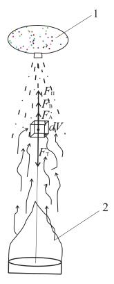
Рисунок 1. Схема тушения пожара МУПП импульсного типа
