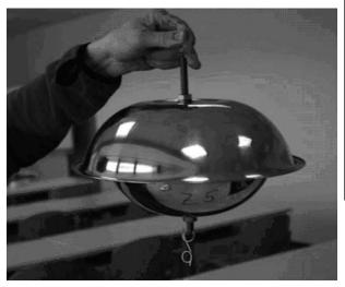
**Рисунок.** Внешний вид пробоотборника для определения CO3 [7]
