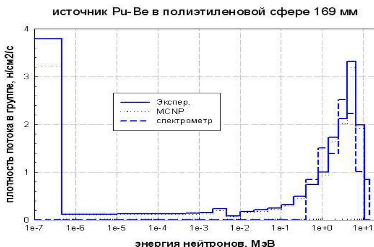
Рис. 1- Спектр нейтронов (плотность потока нейтронов в группе-интервале энергий) источника Pu-Be в полиэтиленовой сфере диаметром 169 мм. «MCNP»- расчет по программе MCNPX; «спектрометр»-результат измерения SDMF-1206; «Экспер.» - результат восстановления по измерениям ДСН-2 с учетом результатов измерений SDMF-1206.
